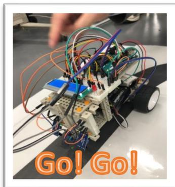
← 学生実験では、Arduinoを使った自動走行ロボットを製作しています。自動放射線検出器の完成を目指して奮闘中です！
